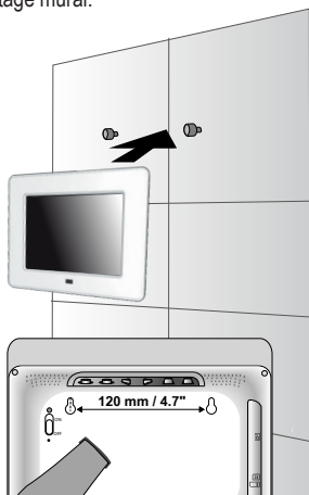
Montage sur un mur
